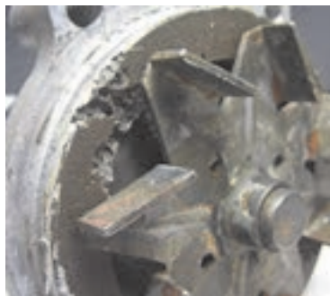
خرابی بلبرینگ و خوردگی داخلی
