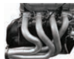
کنترل مانیفولد خروجی (فولادی)
