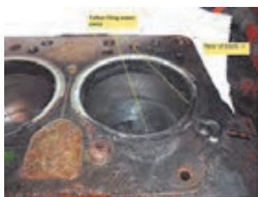
نشستی از محل‌های مختلف بوش سیلندر و واشر سرسیلندر و بالای بوش
