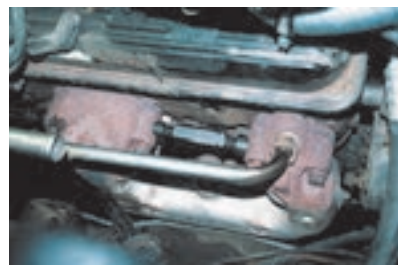
تصویر نشتی دود بین مانیفولد و سرسیلندر
