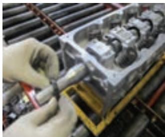
شکل ۵۵-۱ نحوه تعویض کاسه نمد میل سوپاپ با استفاده از ابزار مخصوص
