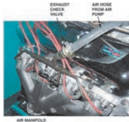
شکل ۳۱-۳ محل نصب و نحوه عملکرد مسدود کننده روی موتور
