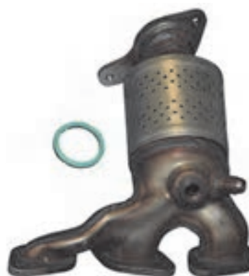
مجموعه مانیفولد خروجی و کاتالیست محل نصب مانیفولد خروجی و کاتالیست روی موتور خودرو شکل ۳-۵ مبدل کاتالیست یکپارچه
