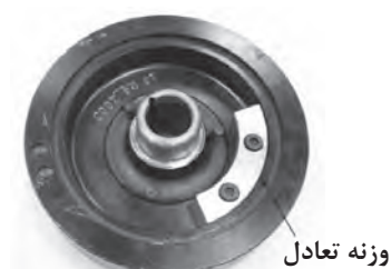
الف) اتصال وزنه بر روی پولی جهت بالانس شکل ۸۵-۲ ب) چسباندن وزنه بر روی صفحه ارتجاعی جهت بالانس (فلاپویل)
