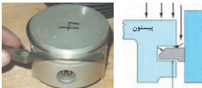
الف) ساییدگی رینگ ب) کنترل خلاصی رینگ و پیستون نو شکل ۲-۱۴۱
