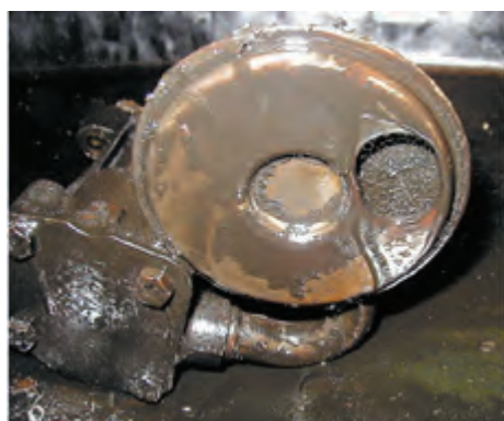
شکل ۲۷-۴ صافی پمپ روغن جرم گرفته
