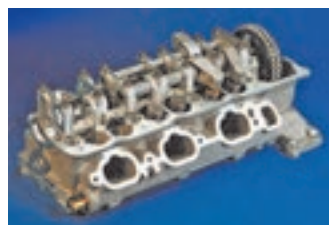
محل نصب مانیفولد خروجی روی
