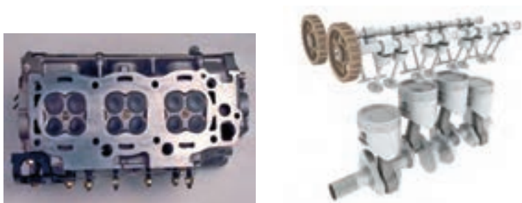
سرسیلندر آلایژ آلومینیومی با دو میل سوپاپ رو (هر سیلندر بیش از ۲ سوپاپ)
