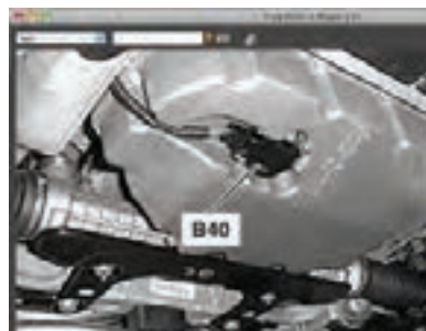
شکل ۱۰-۴ حسگرهای سطح و دمای روغن موتور
