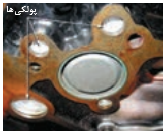
پولکی های نصب شده
